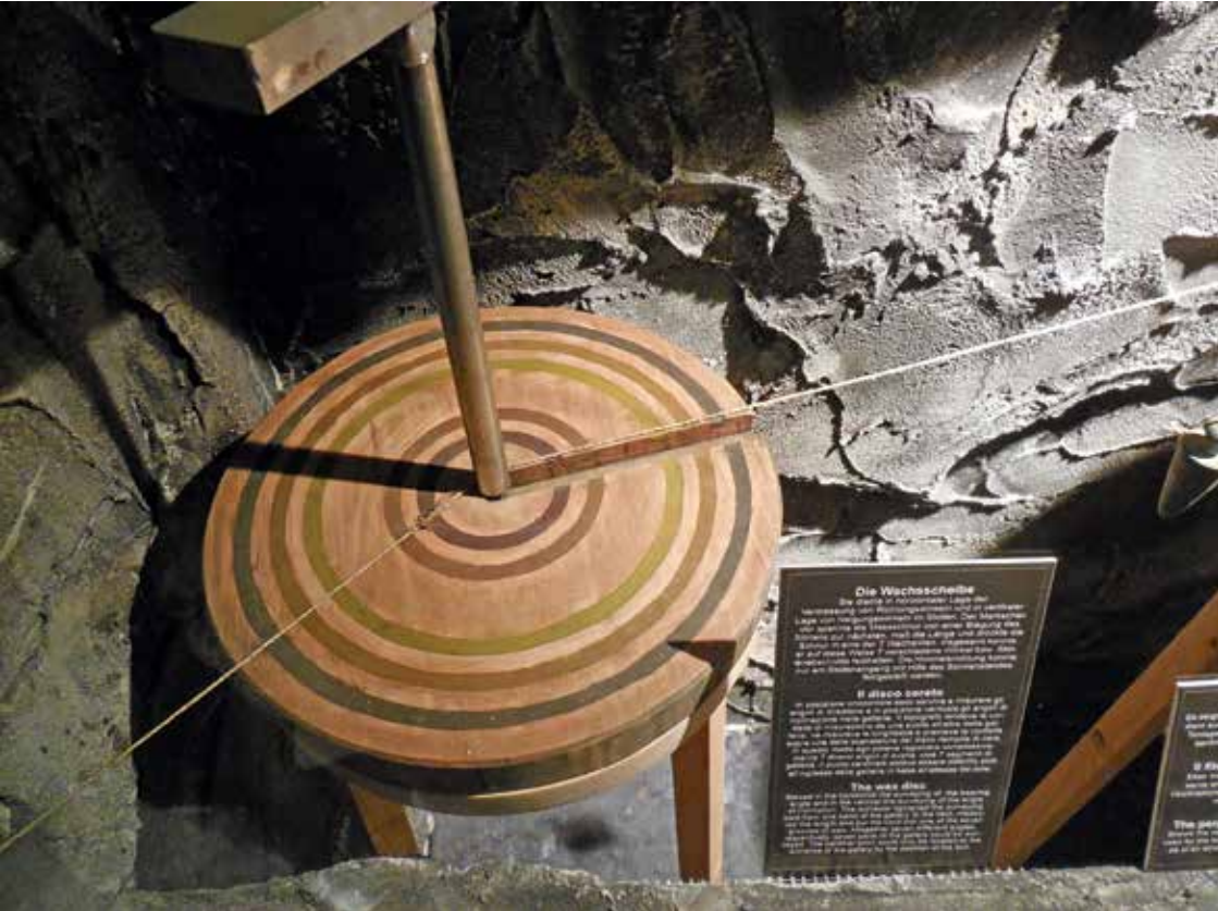
Abbildung 4: Nachbildung eines einfachen Wachsreise mit gespannter Schnur in der Abteilung „Markscheidewesen“ im Südtiroler Bergbaumuseum Ridnaun. Foto: Marcus Wandler, 6. Juli 2014
