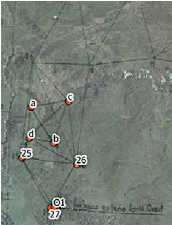
Abbildung 23: Überlagerung des georeferenzierten Dreiecksnetzbildes der Triangulierung von 1942 mit dem amtlichen Luftbild für das Abbaurevier Seemoos, wo sich zw. den Punkten a und b eine Basislinie befand 26
